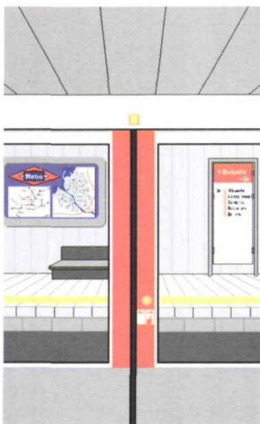
Señal luminosa y acústica sobre la puerta
